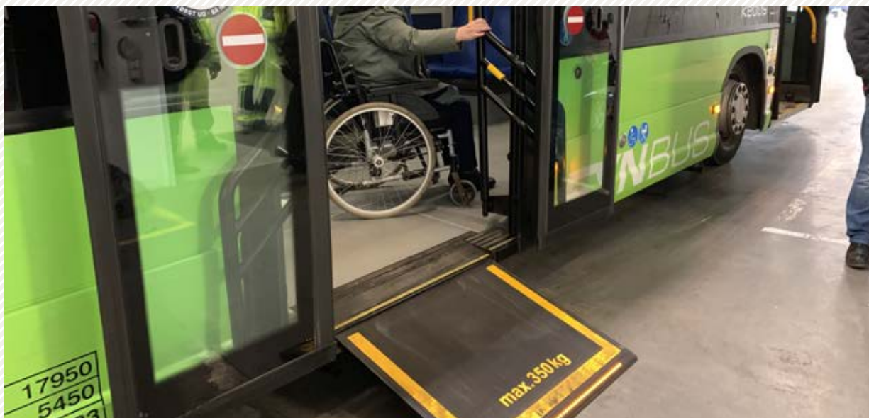
El-rampe ved midterdøren i en af Odenses bybusser.
